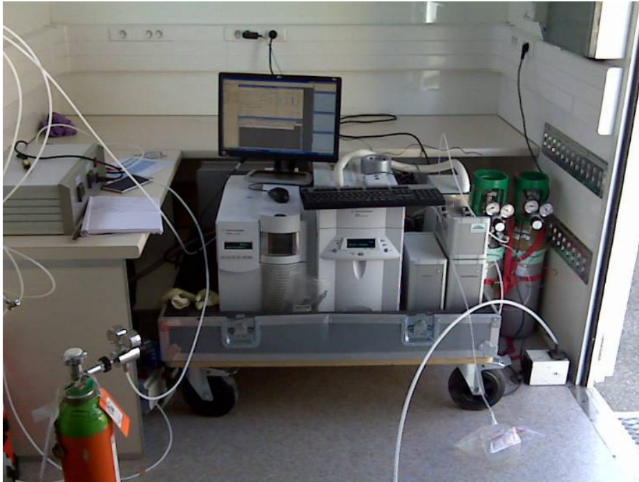
TD/FastGC/MS sur site embarqué dans un véhicule laboratoire
