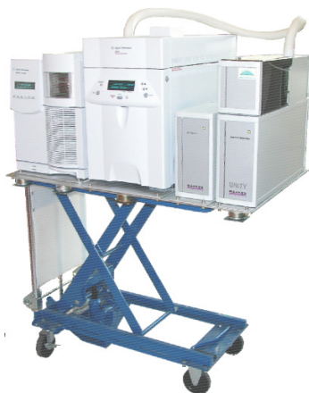
Prélèvement sur site et analyse en direct par Fast TD-GC-MS
